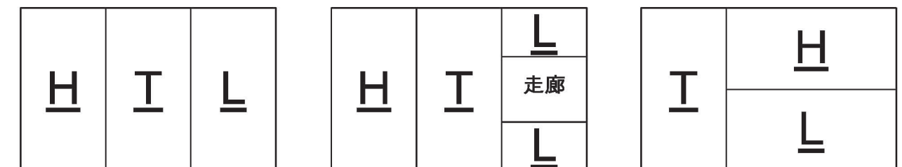
品字型排列(H-高压室 T-变压器室 L-低压室)
